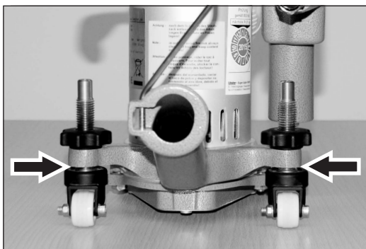
Abb. 66 Einstellung der Lenkrollen für den kurzen Vorsatz und den Eckenvorsatz.
