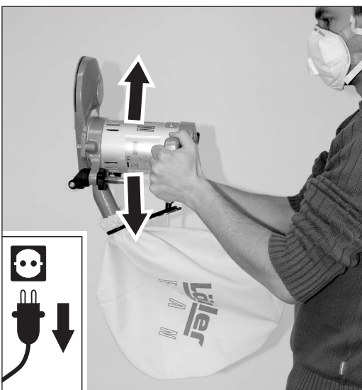
Abb. 30 Die Staubreste aus der Maschine in den Staubsack schütteln.
