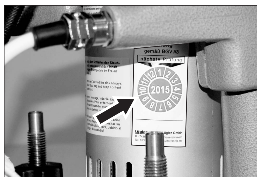
Abb. 81 Das Prüfsiegel am Motorgehäuse bescheinigt die elektrische und mechanische Sicherheit der Maschine und zeigt den nächsten fälligen Prüftermin an.
