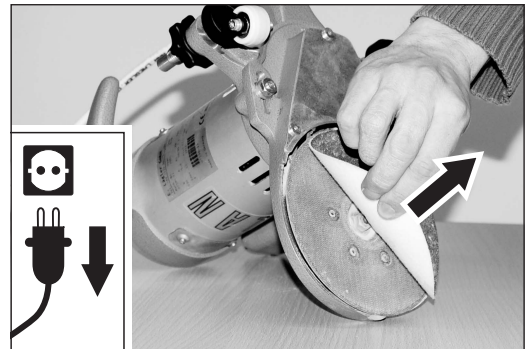
Abb. 16 Die Klettschleifscheibe vom Schleifteller abziehen.
