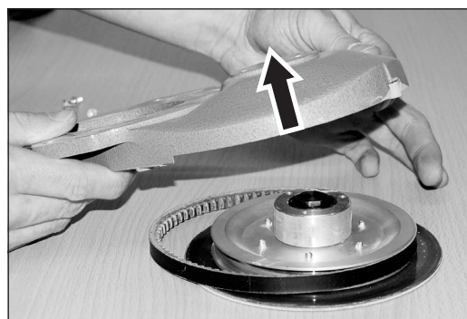
Abb. 50 Den Vorsatz von dem kompletten Schleifteller abnehmen.
