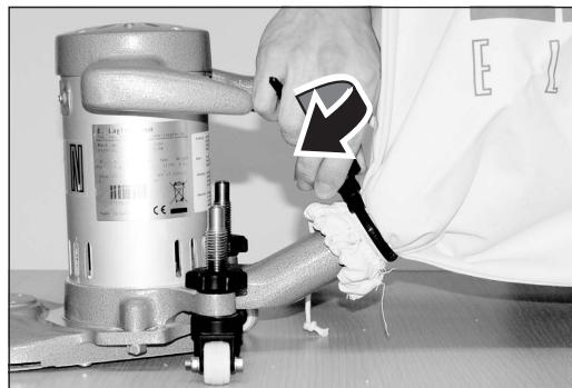
Abb. 8 Die Mutter am MultiClip handfest anziehen.
