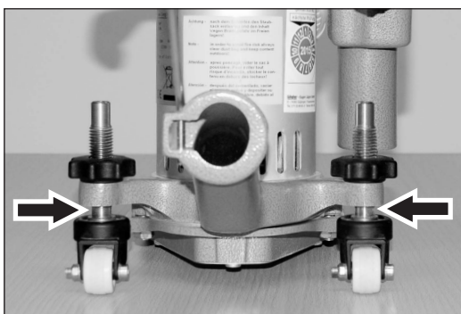
Abb. 67 Einstellung der Lenkrollen für den langen Vorsatz.
