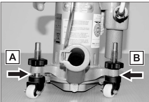
Abb. 77 Die Maschine schleift zu weit rechts : Die linke Lenkrolle ( A ) hebt die Maschine weiter an als die rechte Lenkrolle ( B ).
