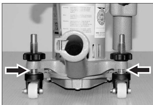
Fig. 33 Le réglage doit être réeffectué après le montage de la nouvelle poulie de guidage (voir section 6.9).
