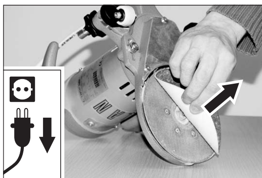
Fig. 9 Retirez tout simplement le disque en velcro ...
