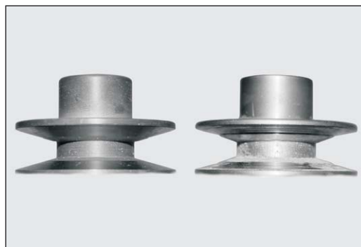
Fig. 34 A gauche, une poulie neuve et, à droite, une poulie usagée qui doit donc être remplacée.
