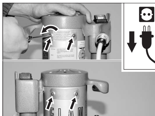
Fig. 27 Dévissez les deux couvercles sur le carter moteur et ...
