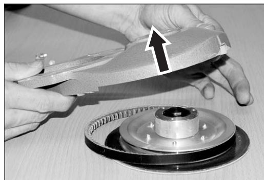
Fig. 22 Retirez la courroie trapézoïdale, remettez une nouvelle courroie en place et ...
