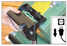
Die Arbeitsleuchte an den Kreuz- Abb. 3 Die Arbeitsleuchte nach links schieben.
