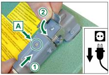
Abb. 5 Den Stecker mit nach oben weisender Schraube [A] einstecken (1) und mit dem Bügel verriegeln (2).
