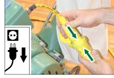
Das Motorkabel in das Verlänge-Abb. 6 rungskabel stecken.
