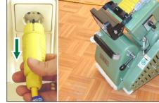
Den Netzstecker in die Steckdose Abb. 8 Den Netzstecker aus der Steckdose Abb. 9 ziehen. Die Arbeitsleuchte geht aus.
